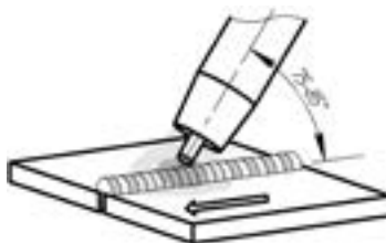
Рис. 8.5. Угол наклона горелки.
