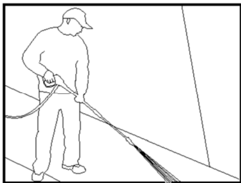
Рис. 6 - Оптимальный угол распыления воды относительно поверхности
